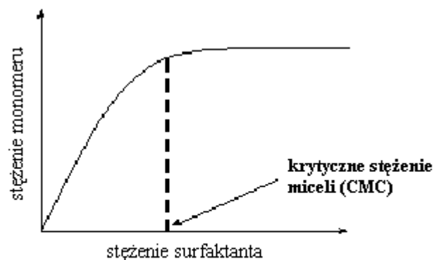
rys 4-3 tworzenie miceli przy krytycznym stężeniu miceli (CMC)
