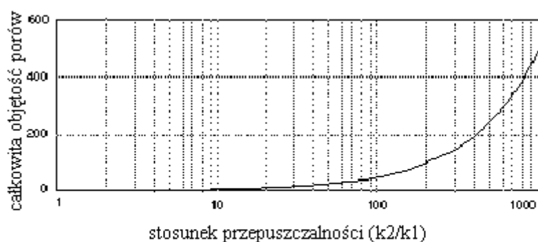
rys. 5-5 objętość porów potrzebna do wprowadzenia jednej objętości porów do warstwy o niskiej przepuszczalności jako funkcja stosunku przepuszczalności
